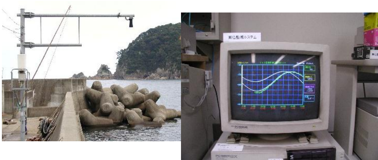
写真 2-4 潮位監視システム（左：センサー、右：監視モニター）
