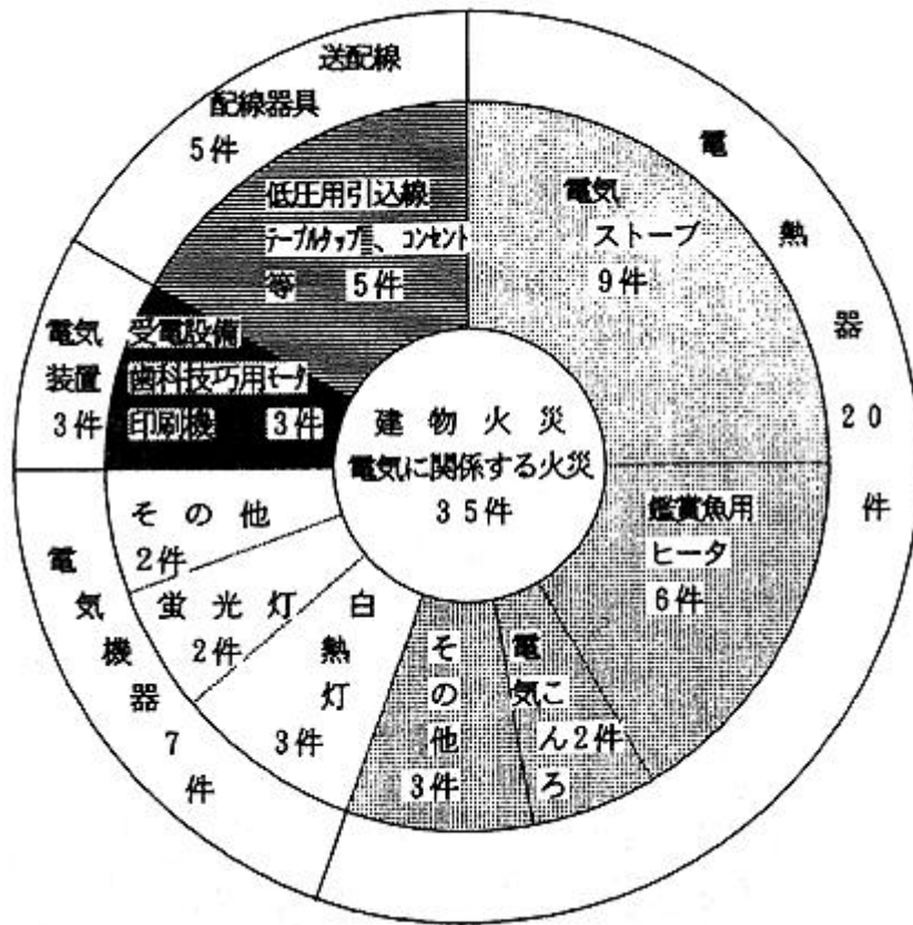
図 2.2.4 建物火災で電気に関する火災
