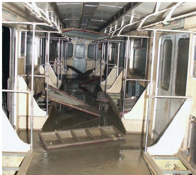
地下に流入した氾濫水により壊れた地下鉄車両 (平成14年:プラハ)
