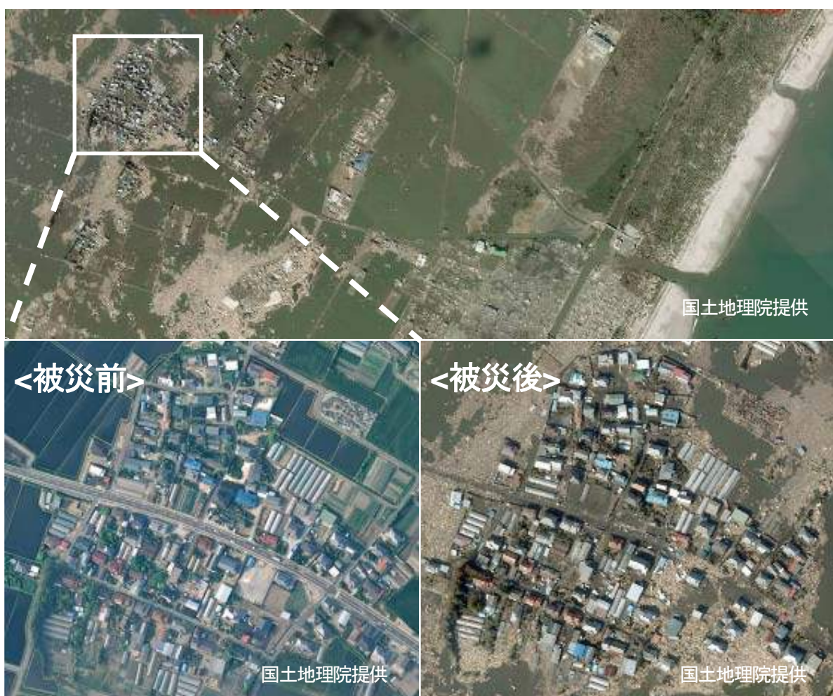
写真 6.4.1-1 最大浸水深が低いため、残存している事例（仙台市若林区荒井笹屋敷）
