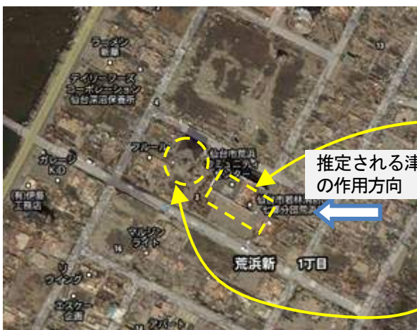
写真 6. 4. 1-4 入射方向に低層 RC 建築物 (浸水深約 6m) があって、残存した木造住宅
