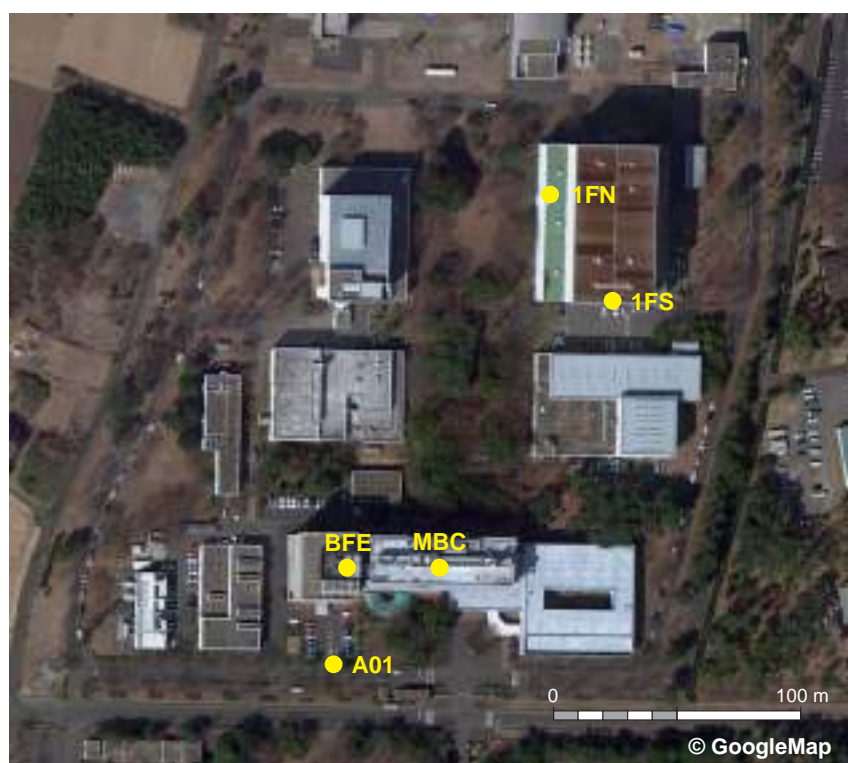
図4.3-9 加速度計の位置。A01は地表、BFE、MBCは地下1階、1FS、1FNは1階(航空写真はGoogle Mapより)
