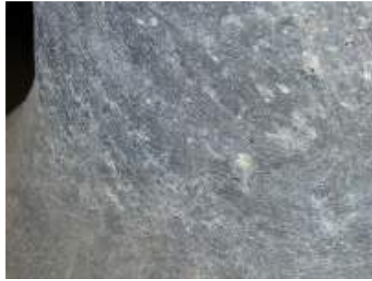
写真 5. 5. 1-52 鉛ダンパー表面の微細な亀裂
