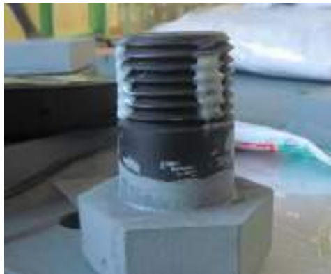
写真 5.5.3-2 ボルト部への接着剤塗布状況 5.5.3-13)
