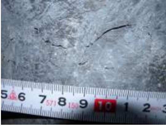
写真 5. 5. 1-52 鉛ダンパー表面の微細な亀裂
