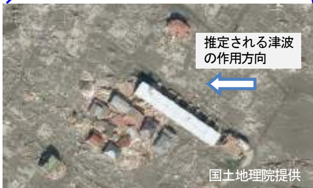
写真 6. 4. 1-4 津波の入射方向に建つ建築物により津波波力が軽減し、残存したと考えられる例 (名取市閑上地区)
