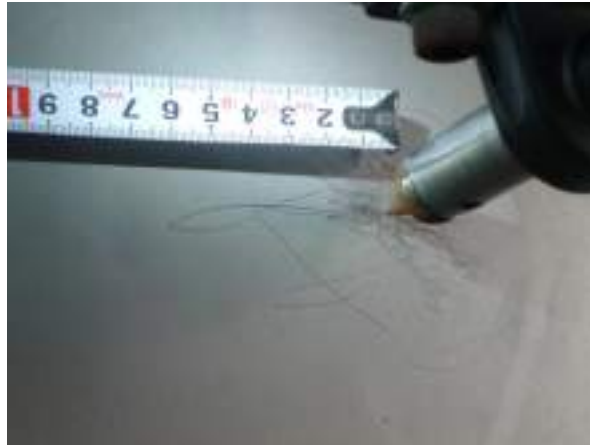
写真 5.5.1-51 罫書き式変位計の免震層変位記録
