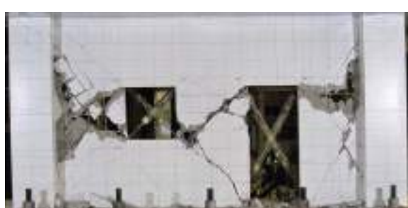
(d) 1/100rad. 加力終了時 (最大ひび割れ幅 → 計測終了)
