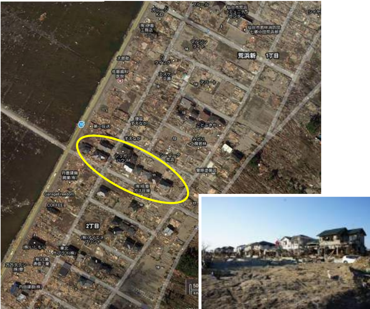
写真 6. 4. 1-5 入射方向先頭に鉄骨造住宅があって列状に残存した木造等住宅群（仙台市若林区）
