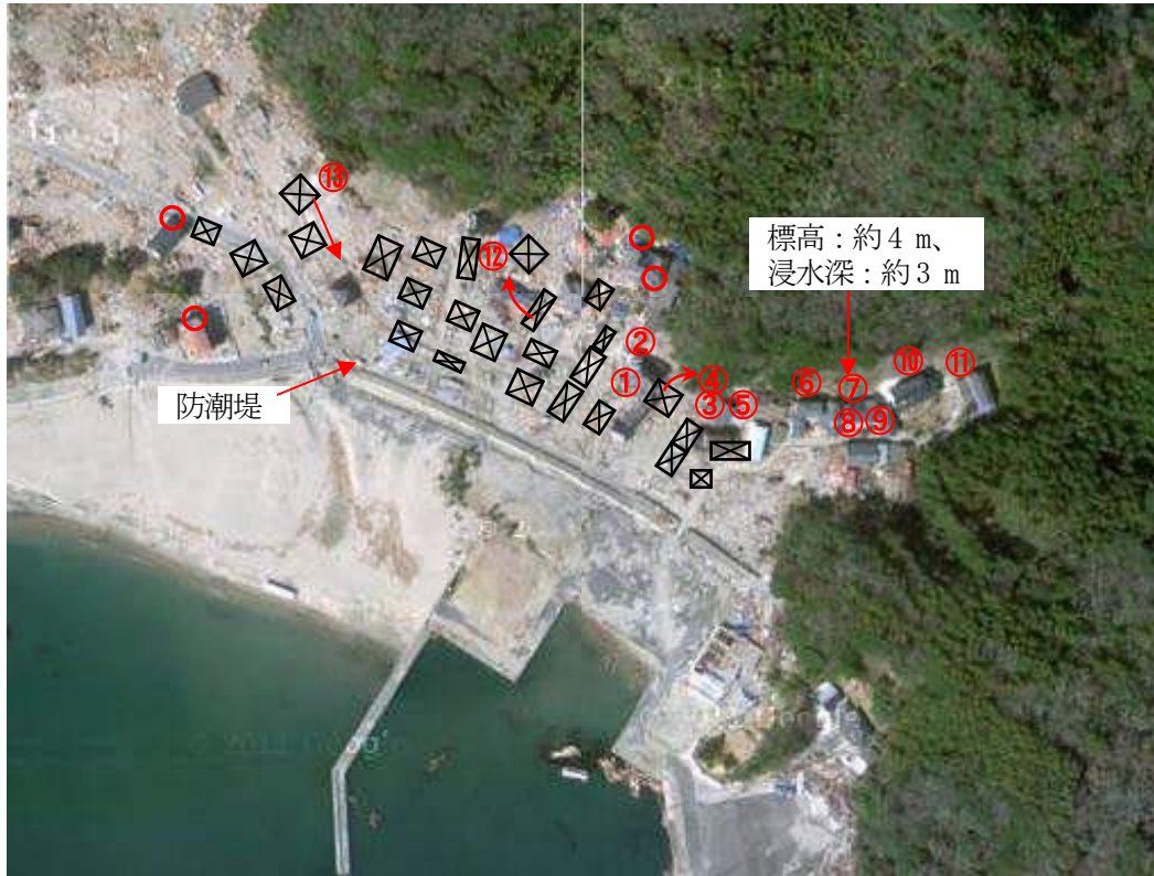
図 20.1 東松島市宮戸島大浜地区の航空写真 (☒ : 流失した建築物、○ : 残存する建築物)
