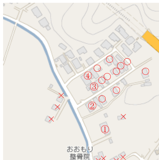
図 2.2 大槌町第 24 地割南東部の残存・流失建築物の分布 (○, 丸数字 : 残存建築物、× : 流失建築物、無印は未調査)
