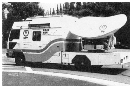
写真1 衛星通信車載車
