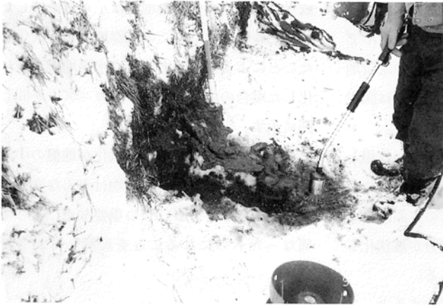
写真3 ガスバーナーで溶かした雪の下から出てきた噴砂の痕跡
