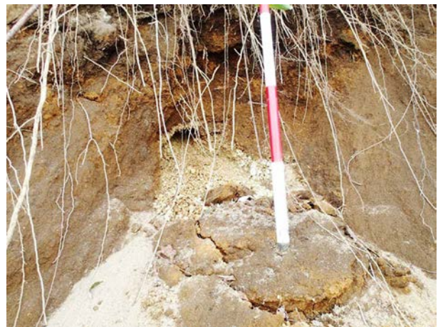
図4 吉野地区の崩壊現頭部に見られた軽石層の噴出口
