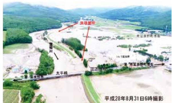
写真1 空知川の破堤（南富良野町）
